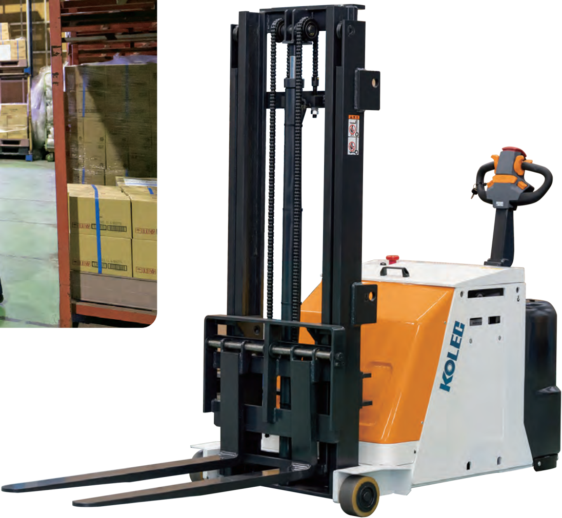
全車ゴムスカート付き 車体の下につま先が入り込む事を防止します。
