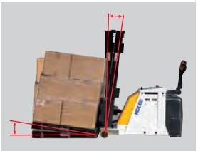
ティルト機能 落下を防ぐために少し後傾させて走行できます。
