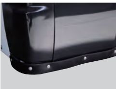
全車ゴムスカート付き 車体の下につま先が入り込む事を防止します。
