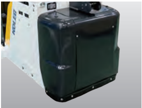
全車ゴムスカート付き 車体の下につま先が入り込む事を防止します。
