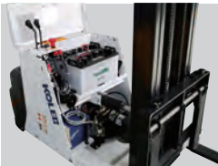
点検も容易 フルオープンカバー採用でメンテナンスが容易です。
